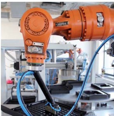
Obr. 5 Robotické pracoviště pro automatickou depaletizaci a montáž stoliček v Českém Těšíně
